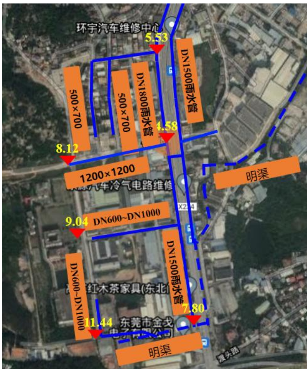
图5.2-44 设计范围现状雨水管线图
