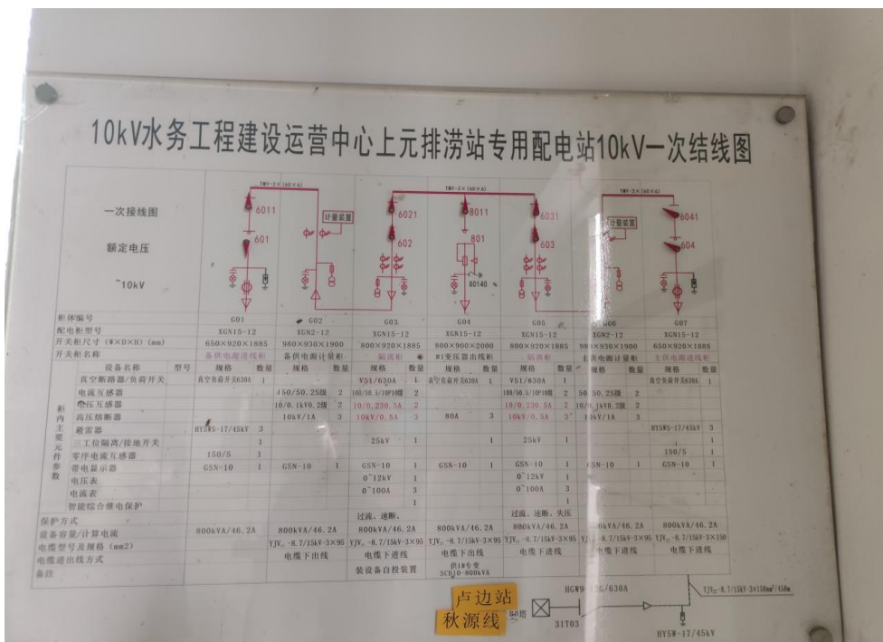
图5.2-89 上元新排站高压主接线图
