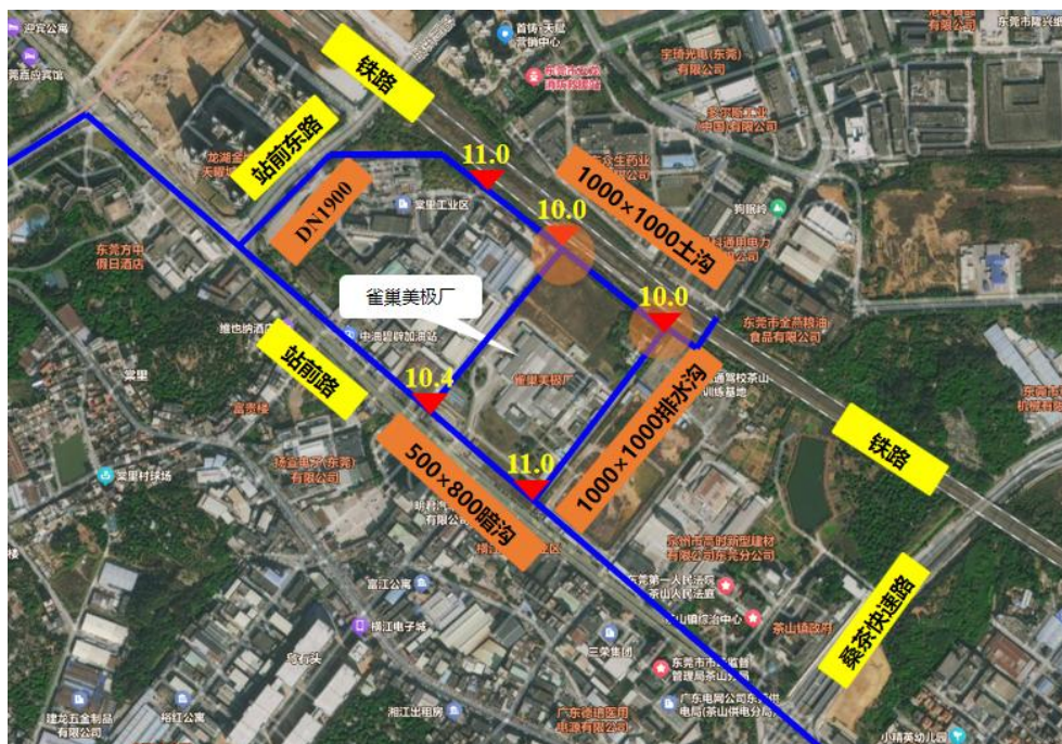
图5.2-20 设计范围现状雨水管线图
