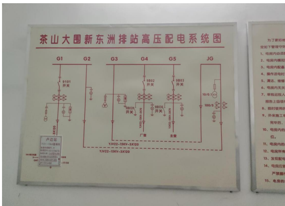
图5.2-85 东洲新排站高压主接线图
