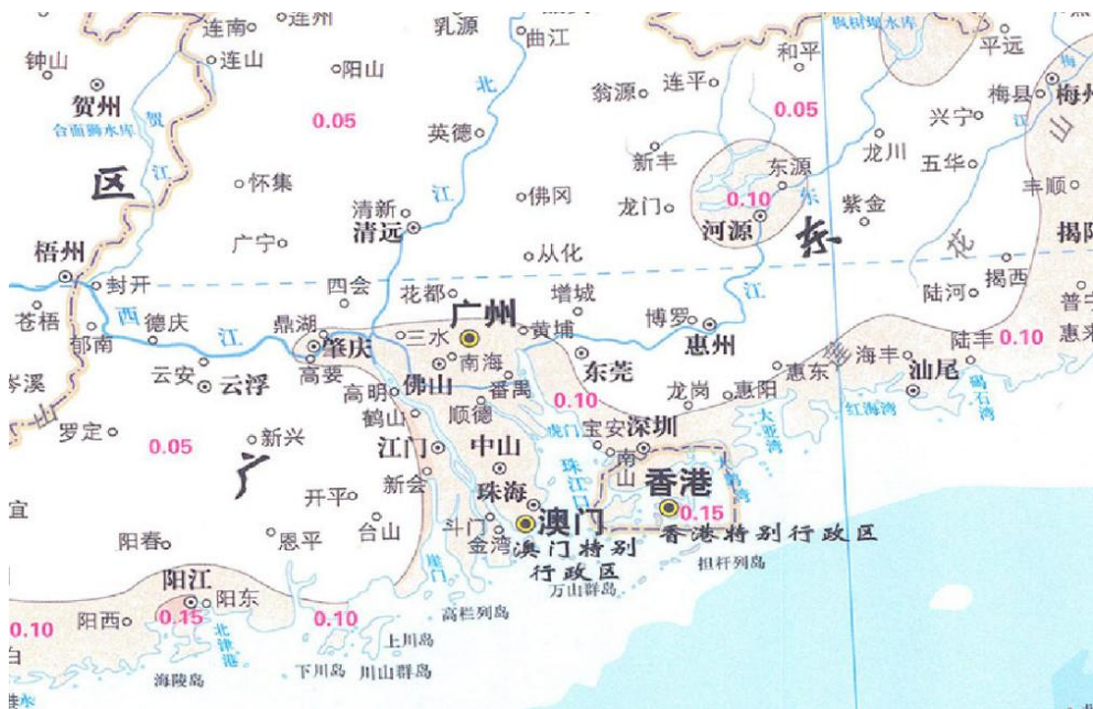
图5.2-104 工程区地震动峰值加速度区划图
