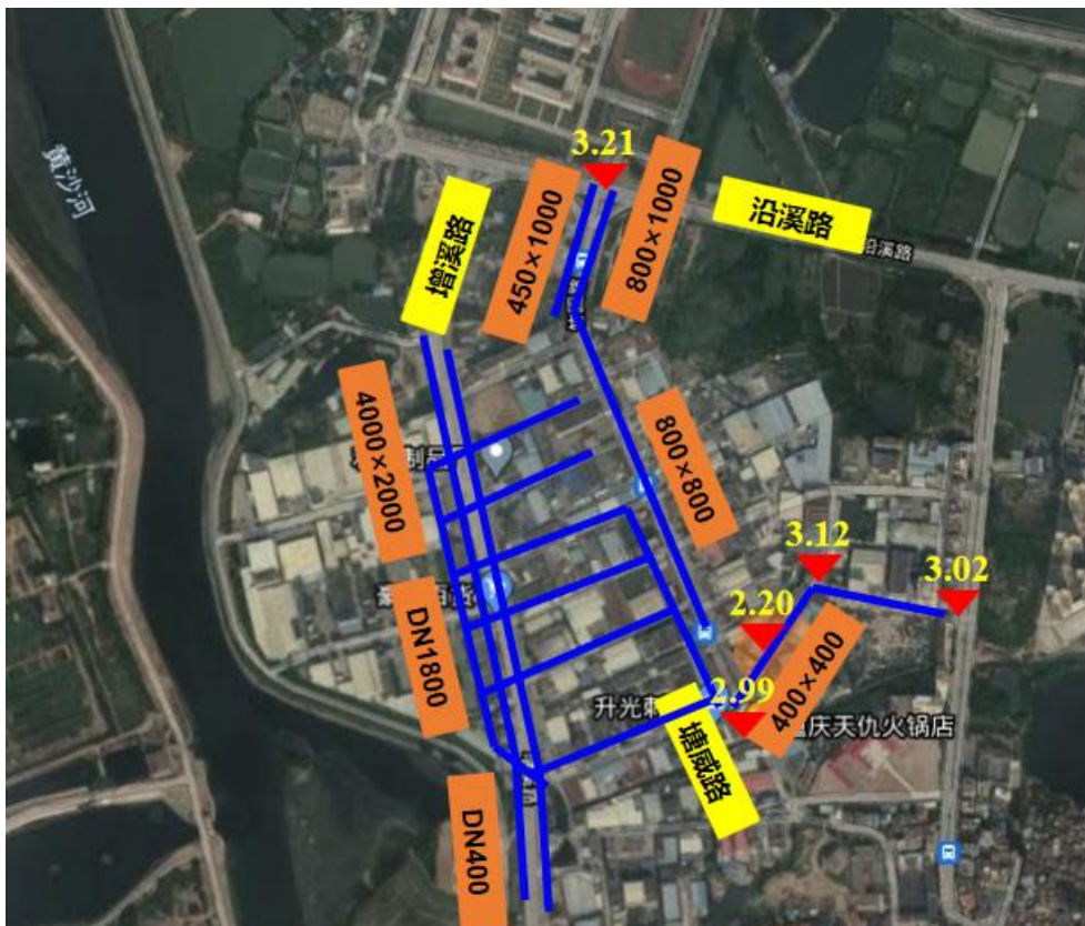
图5.2-38 设计范围现状雨水管线图
