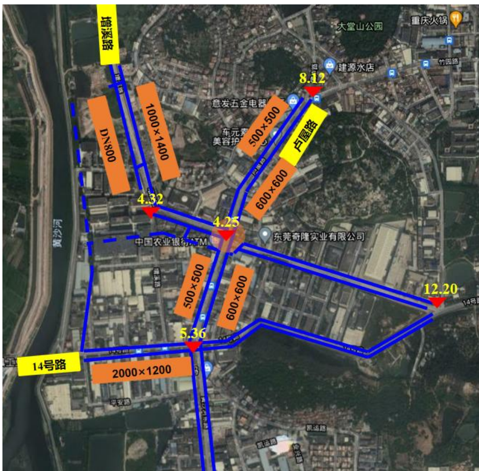
图5.2-31 设计范围现状雨水管线图
