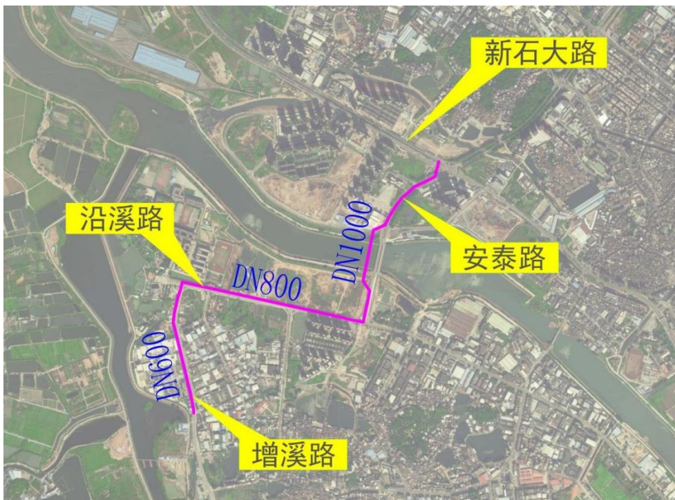
图3.1-6 水主干管D线示意图
