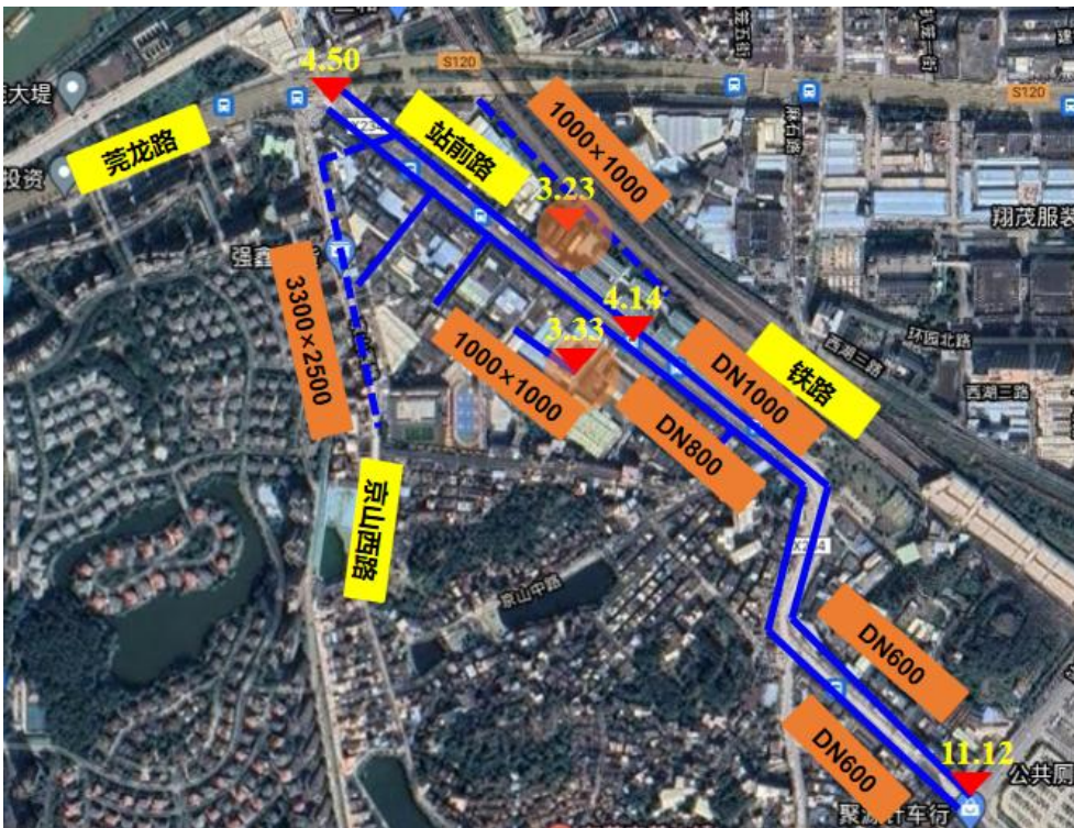
图5.2-51 设计范围现状雨水管线图
