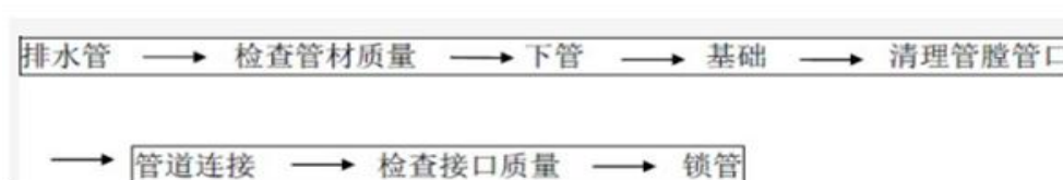
图5.2-110 管道安装工艺流程图
