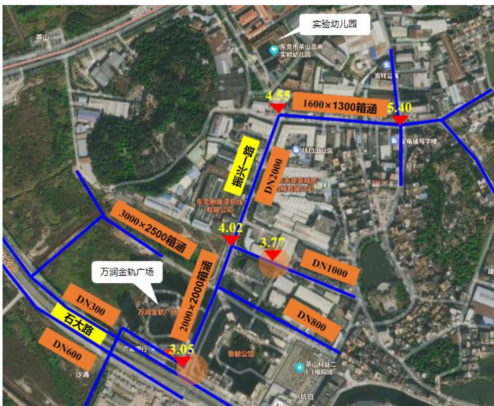
图5.2-13 设计范围现状雨水管线图
